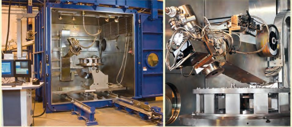
西亚基的电子束焊接系统是市场上最常用的。其多轴移动焊枪所需的操作空间只是普通固定焊枪的一半，为焊接特殊接头提供了更多的操作空间，并简化了部分机床安装。
