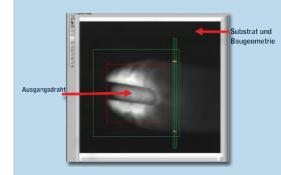
Das EBAM-Paket steuert die Strahlgeometrie mit hoher Präzision für eine hervorragende Energieverteilung auf dem Schmelzsee und dem Draht, was eine wiederholbare Vorformfertigung ermöglicht. Das System muss nur minimal gewartet werden und die EBAM-Filamente können in 10 Minuten am Ende oder am Beginn jedes Kammerzyklus ausgetauscht werden.
