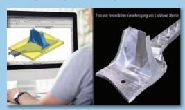
Ausgehend von einem 3D-Modell aus einem CAD-Programm trägt die voll bewegliche Elektronenkanone von Sciaky Metall schichtweise über einen Ausgangsdraht auf, bis das Werkstück fertig und für die abschließende Nachbearbeitung bereit ist.
