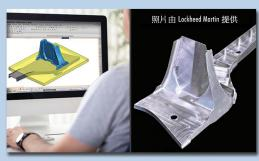
從 CAD 程式中的 3D 模型開始, Sciaky 的全聯結移動式電子束槍逐層熔敷金屬(經由線材進料), 直至部件構造完成, 準備好進行機械精加工。熔敷率的範圍通常為 7 到 20 lbs/hr (3 到 9 kg/hr), 具體取決於部件幾何形狀和選擇的材料。
